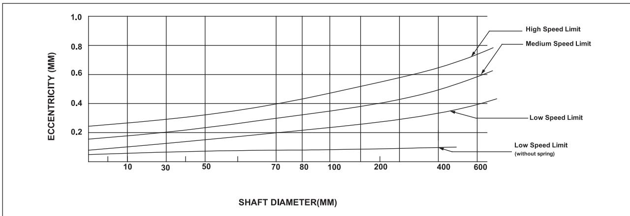
Fig. 5 : Shaft eccentricity limits
