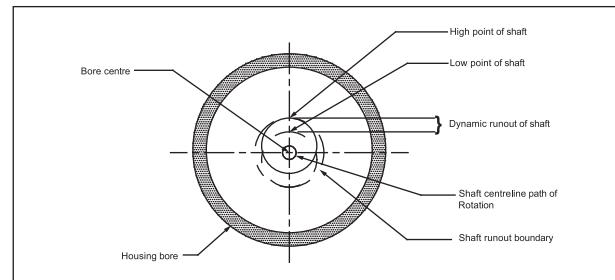
Fig. 4 : Shaft runout
